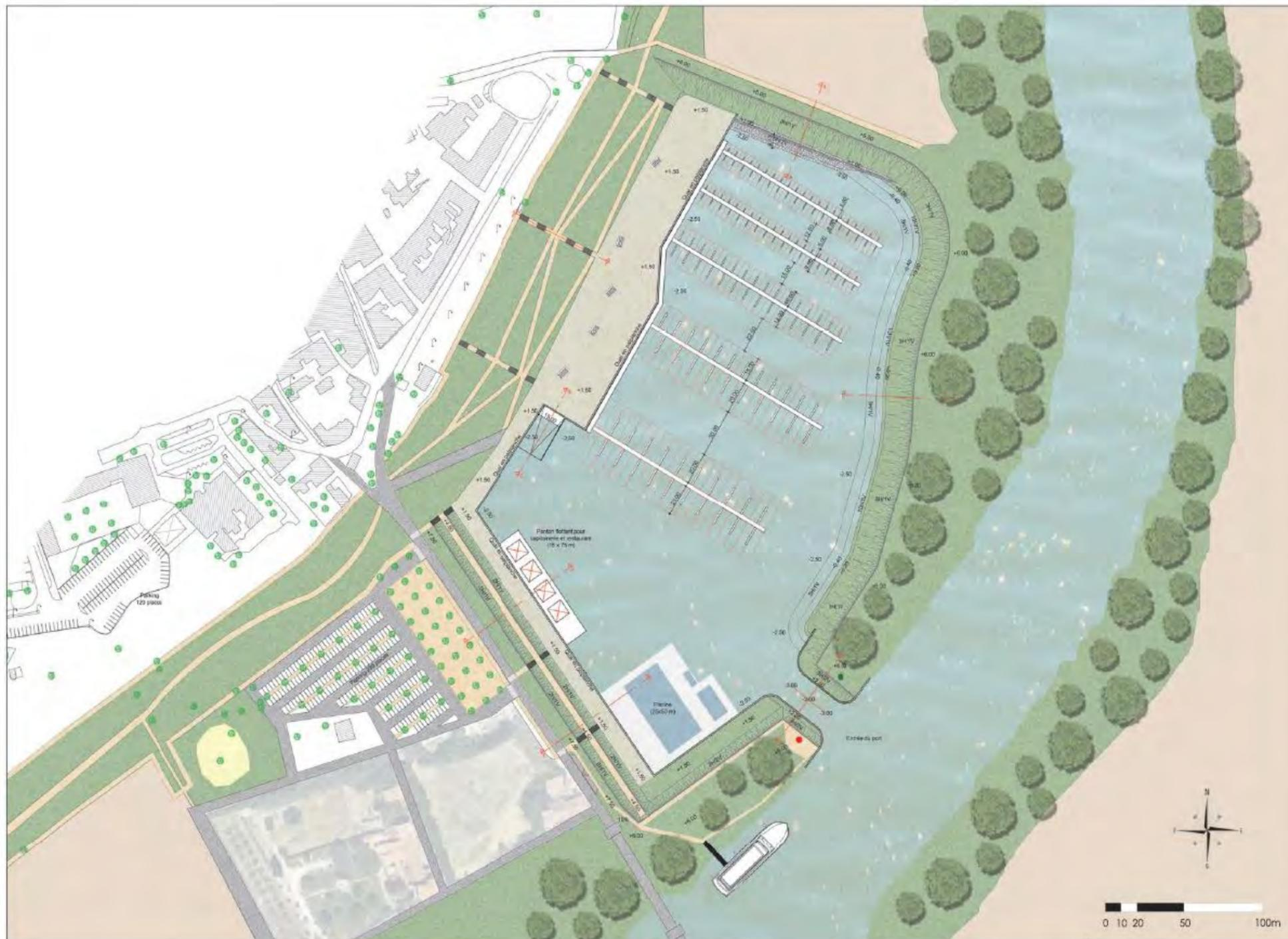
Figure 14 : Schéma du scénario 1 « aménagement de type portuaire »
