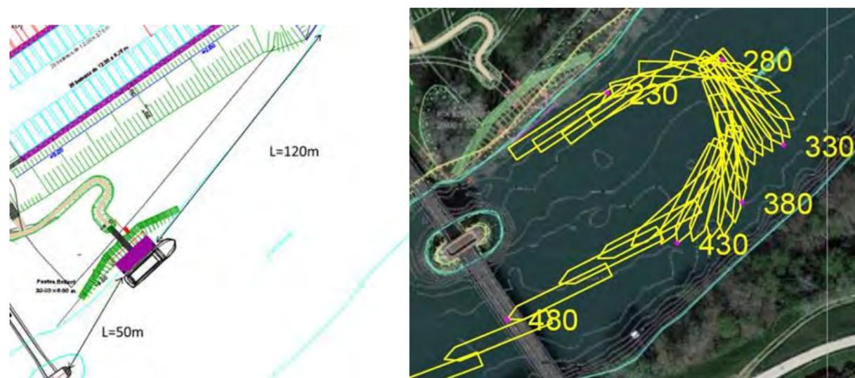
Figure 13 : Emplacement du ponton d'accueil et extrait manœuvre (vent Nord 32.4km/h, courant annuel)
